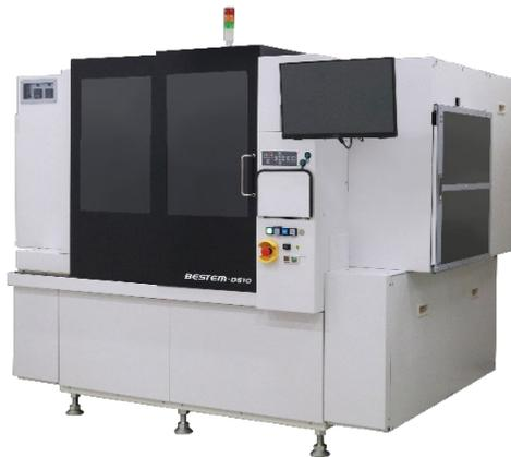
BESTEM-D610は、12インチウエハー対応 IC/LSI（大規模集積回路）用のダイボンダーです。対象チップサイズを従来機種（BESTEM-D510）の8mmまでから15mmまでと拡大したこと、従来の個別オプション機能を標準搭載したことで、幅広いニーズに応えます。新たに開発したボンディングヘッドおよびディスペンユニットの搭載によりパフォーマンスを改善したことで、顧客の生産性と製品品質の向上に貢献します。また、操作画面やデータ表示機能などUIを刷新し、より直感的な操作が可能となりました。
